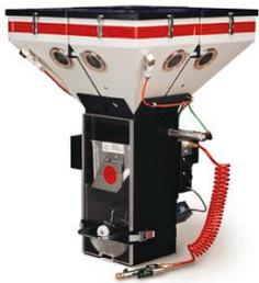
**Der WSB MB – Micro Blender:** besteht aus 4 abnehmbaren Materialtrichtern mit vertikalen Ventilen. Die Materialtrichter sind auf einem robusten und kompakten Metallgestell aufgesetzt, welches die Wiegezone und einen Mischer beinhaltet. Geeignet für 4 Komponenten und bis zu 45 kg/h Durchsatz.
