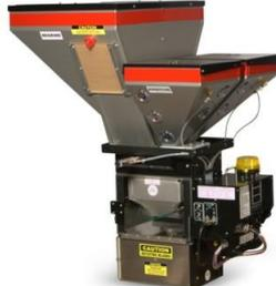
**Der WSB 240 R:** besteht aus einem unterteilten Materialtrichter mit 2 pneumatischen Schiebern für hohe und 2 abnehmbaren Materialtrichtern mit vertikalen Ventilen für kleine Materialdurchsätze. Die Materialtrichter sind auf einem robusten und kompakten Metallgestell aufgesetzt, welches die Wiegezone und einen Mischer beinhaltet. Geeignet für 4 Komponenten und bis zu 400 kg/h Durchsatz.
