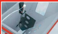
Gamme de déviateurs pour aider au maintien d'un écoulement constant de matières rebroyées/flocons.
