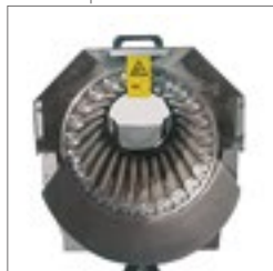
Detail: Separating roller Particolare: Rulli separatori
