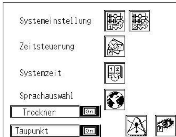
Im Bild der Trocknerparameter kann der Umschalt-Taupunktwert eingegeben werden. Dieser Wert bestimmt den Zeitpunkt der Umschaltung zwischen den beiden Trockenmittelbehältern nach der jeweiligen Regenerations- bzw. Kühlphase.
