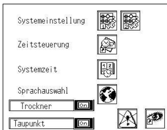
Des weiteren können von diesem Menü aus das Trocknerparameter-, das Zeitsteuerungs- und das Systemzeit-Bild aufgerufen werden. Ebenso kann die Menüsprache hier ausgewählt werden.
