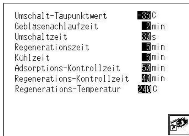
Hierdurch wird ein unnötig vorzeitiges Umschalten vermieden. Die dadurch verlängerten Pausenzeiten zwischen den einzelnen Regenerationsphasen können erheblich zur Energieeinsparung beitragen, da während diesen Pausenzeiten die Regenerationsheizungen ausgeschaltet bleiben.
