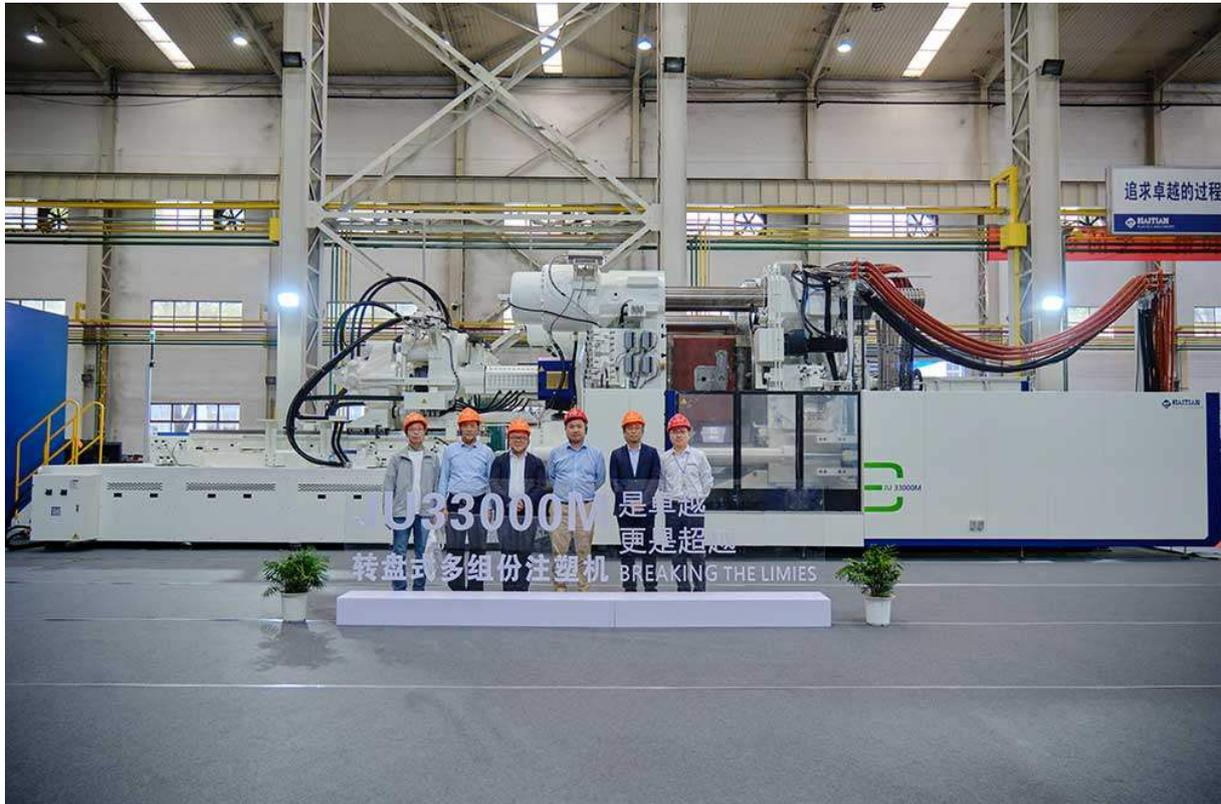
Am 9. Mai fand die offizielle Abnahme der Mehrkomponenten-Drehtisch-Spritzgießmaschine JU33000M statt, was einen bedeutenden Meilenstein für HAITIAN International darstellt. Diese Multimaschine stellt mit ihrer Schließkraft von 33.000 kN, einem maximalen Drehtischdurchmesser von 3,1 Metern und einer maximalen Tragfähigkeit von 28 Tonnen einen Weltrekord auf. Dies stellt einen neuen Meilenstein in den technischen und Fertigungskapazitäten von HAITIAN dar.
