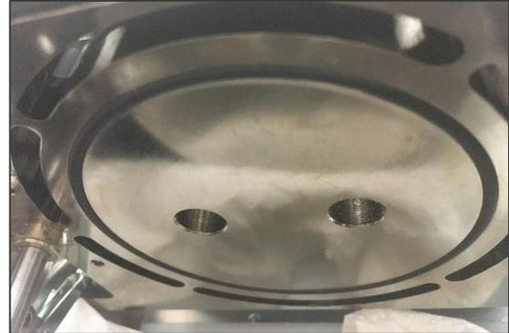
Hierzu stellt man das Gerät ab, öffnet den Reaktor, entnimmt das Reagenzbett und die Probenschale. Die Säuberung erfolgt am besten mit einem Papiertuch, das mit Spiritus angefeuchtet (nicht tropfnass!) wurde und wischt die betroffenen Stellen ab. Insbesondere die Deckelfläche der Probenschale kann so gesäubert werden.
