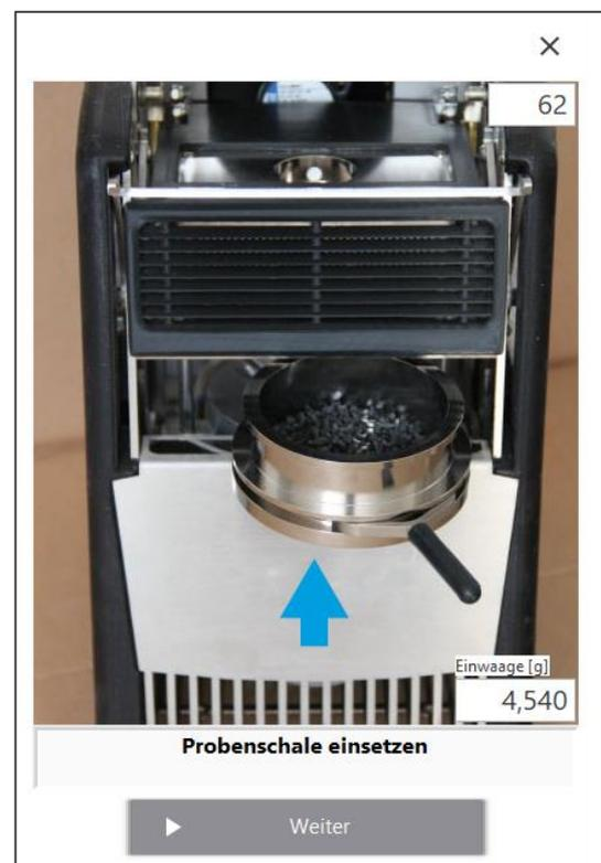
Setzen Sie die Probenschale ein. Achten Sie darauf, dass der untere Rand der Schale über der Heizplatte liegt
