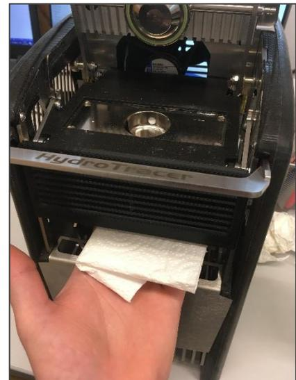
Die Steigrohre lassen sich am besten mit einer Reagenzglas-Bürste von oben säubern (siehe Foto). Hierbei sollte die Probenschale eingesetzt sein, um die Verschmutzung der Heizplatte zu vermeiden.
