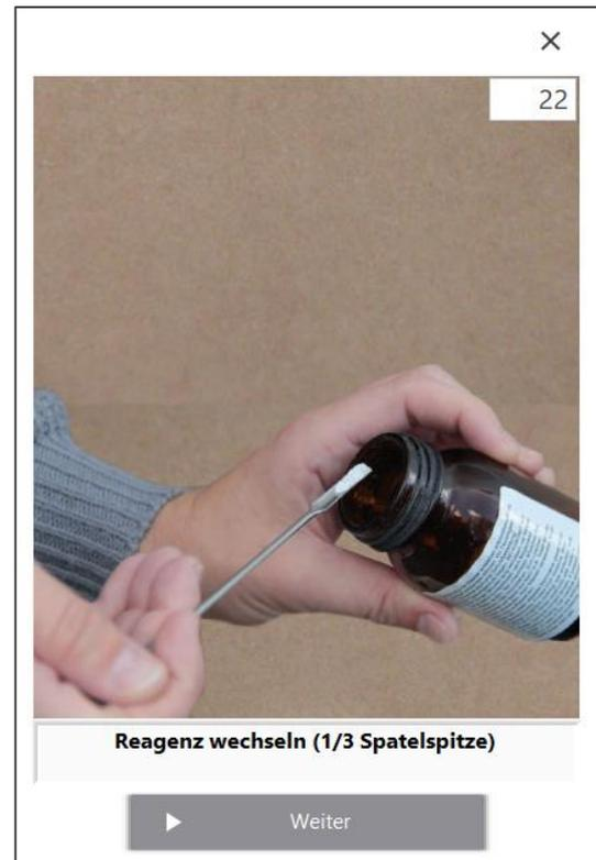
Entnehmen Sie mit dem löffelförmigen Ende des Spatels das Reagenz (ca. 1/3 der Löffelfläche) und befüllen Sie das Reagenzbett.
