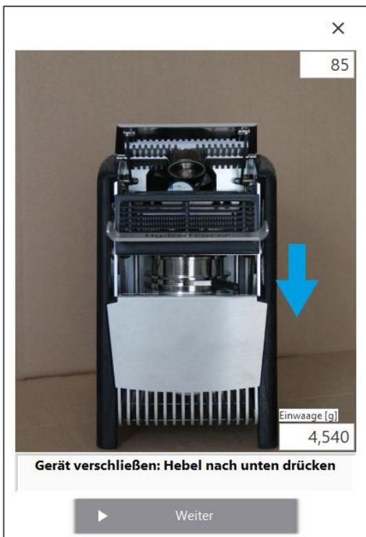
Schließen Sie das Gerät durch Herunterdrücken des Ein-Hand-Hebels. Der Systemlüfter muss jetzt wieder anlaufen. Sie können die Messung mit „Weiter (F10)“ beginnen.
