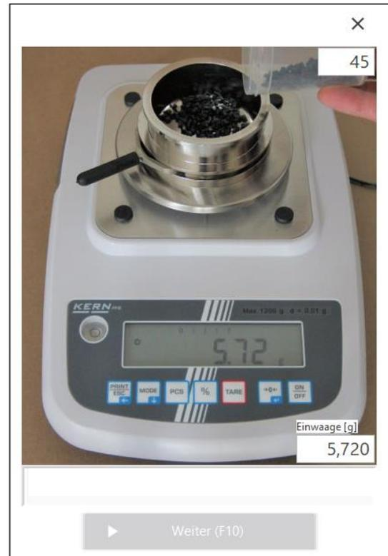
Senden Sie die Daten der Waage durch Drücken der „Print“-Taste. Im Feld „Einwaage[g]“ erscheint das übermittelte Gewicht.
