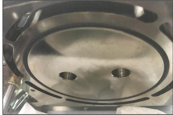
Wenn sich das Reagenz im Reaktor verteilt hat, empfiehlt es sich ebenfalls, den Reaktor zu säubern. Befindet sich das Pulver lediglich im Bereich des Reagenzbettlagers, öffnet man einfach den Reaktor, entnimmt das Reagenzbett und bürstet das Pulver durch die Steigrohre in die Probenschale. Auch mit trockener Druckluft (Mindestabstand 15 cm!) lässt sich der Reaktor säubern.
