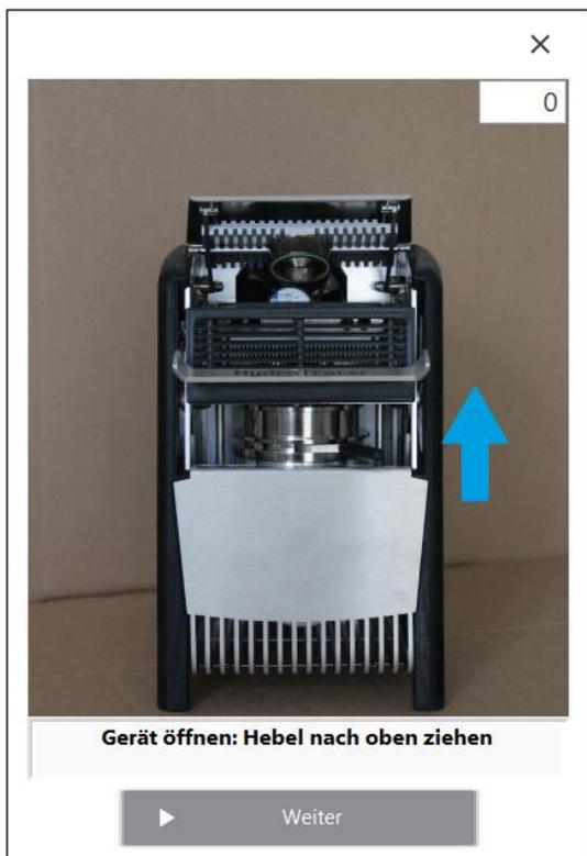
Öffnen Sie den die Testkammer durch Hochziehen des Ein-Hand-Hebels bis zum Anschlag. Der Systemlüfter wird dabei ausgeschaltet.
