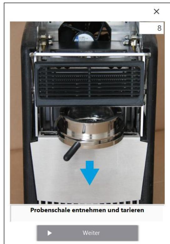
Entnehmen Sie die Probenschale. Entfernen Sie altes Probenmaterial. Stellen Sie die Probenschale auf die Waage und tarieren diese.
