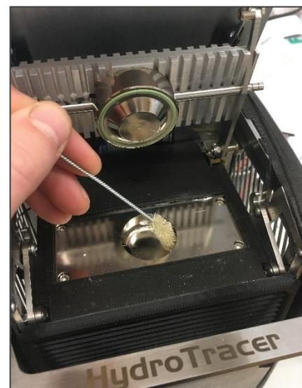
Nach der Säuberung ist unbedingt zu kontrollieren, ob der Dichtring sauber ist. Natürlich lassen sich so auch die oberen Bereiche des Reaktors säubern
