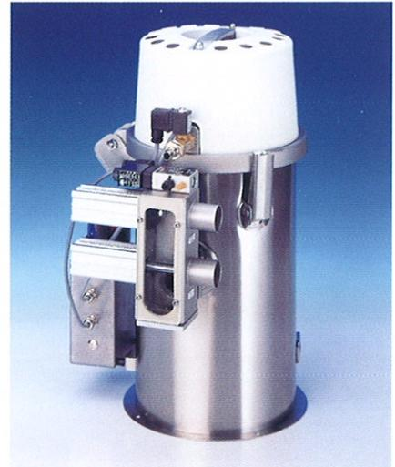
Die Mischventile MZ 38 und MZ 50 ermöglichen die automatische Zudosierung eines Zweitmaterials wie z.B. Mahlgut. Die Zusatzmenge kann in Prozent vorgewählt werden. Das pneumatisch betriebene Mischventil wird von einer Elektronik gesteuert, die für eine Verteilung der Förderzeiten sorgt, so daß während eines Förderzyklus beide Komponenten im Abscheider durch die Strömung gemischt werden.
