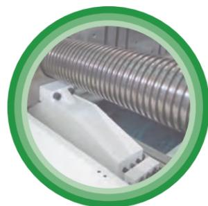
Verbesserte Stabilität der beweglichen Platte für garantierte Plattenparallelität bei größeren Werkzeugen mit mehr Gewicht, eine reduzierte Plattenneigung und höhere Präzision.
