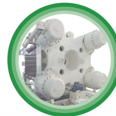
Parallele Verriegelung von Holm und Nut sorgt für eine schnelle und genaue Reaktion.
